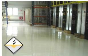
Im AS-Beschichtungssystem wird die **cds-Beschichtung HB-AS**, ein pigmentiertes elektrostatisch ableitfähiges 2-Komponenten-Epoxidharz, als glatte Deckschicht eingesetzt.
